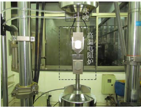
图 2 微动疲劳试验装置 Fig. 2 Fretting fatigue test device
